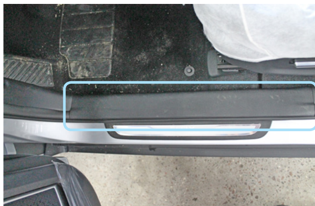
Фото 1.6. Пластиковая накладка порога двери водителя
