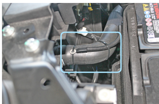
Фото 2.8. Крепление датчика температуры двигателя
