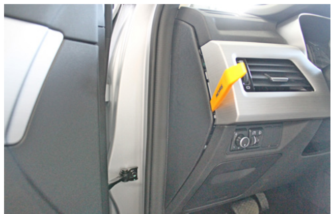
Фото 1.2. Снять левую боковую накладку передней панели
