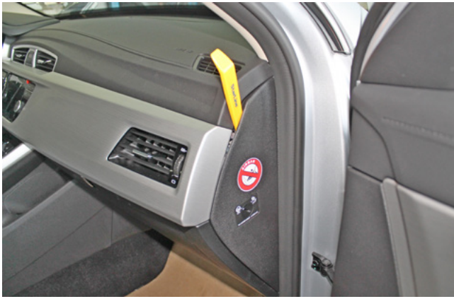
Фото 1.11. Снять правую боковую накладку передней панели
