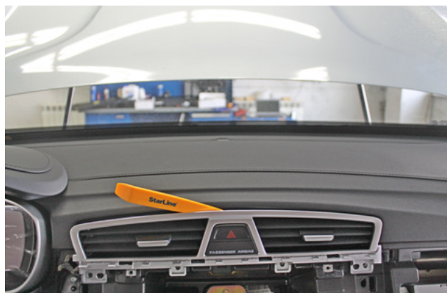
Фото 1.23. Снять центральные воздуховоды
