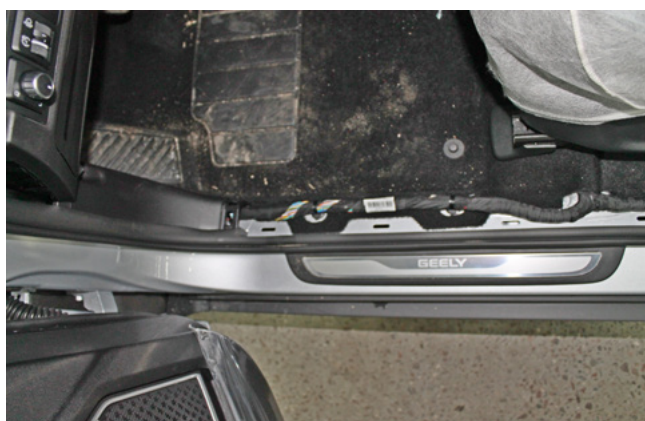
Фото 1.7. Накладка порога двери водителя снята
