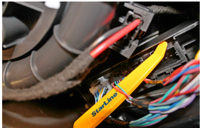
Фото 3.17. Провода штатной антенны в жгуте чёрного разъёма блока PEPS (розовый и зелёный)
