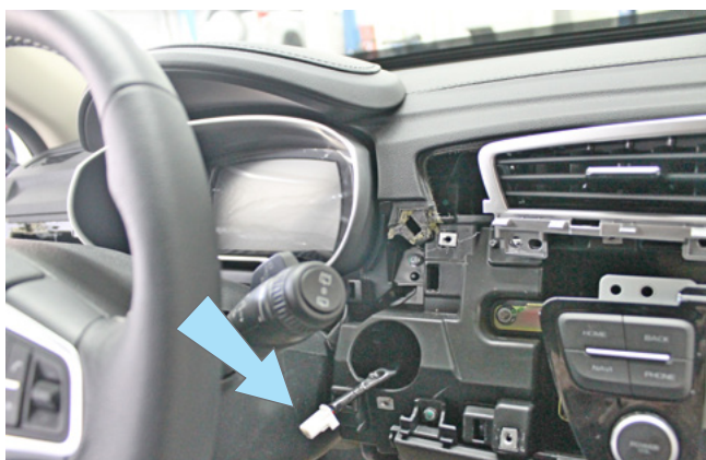
Фото 3.10. Местоположение разъёма кнопки Старт-Стоп
