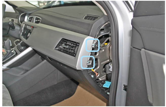
Фото 1.12. Боковая накладка передней панели снята. Саморезы крепления накладки передней панели
