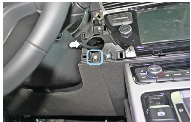
Фото 1.16. Саморез крепления накладки под рулевой колонкой
