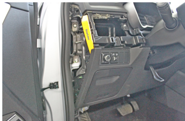
Фото 1.18. Снять пластиковую накладку под рулевой колонкой
