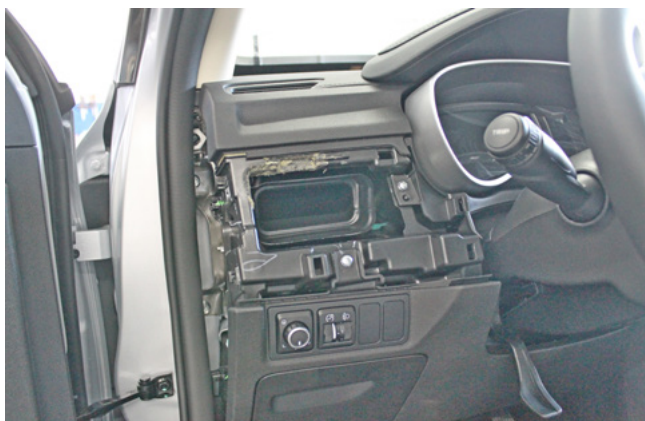
Фото 1.5. Левый воздуховод снят
