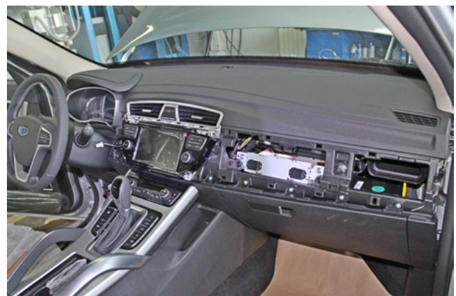
Фото 1.14. Пластиковая накладка передней панели снята
