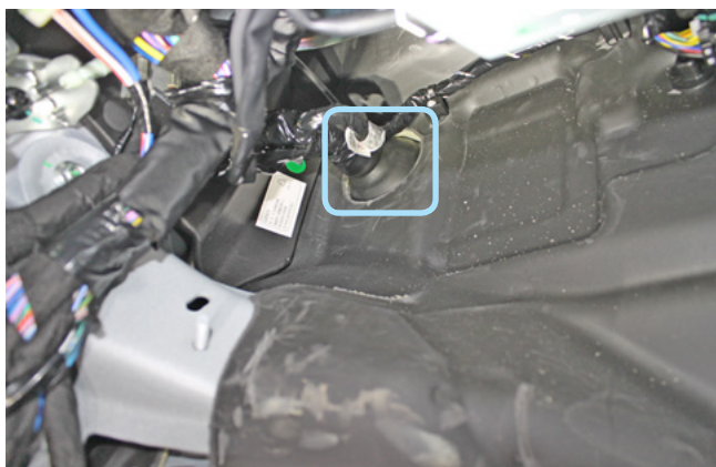
Фото 2.9. Штатный уплотнитель. Вид со стороны салона
