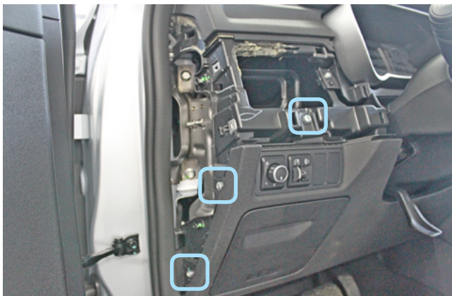
Фото 1.15. Саморезы крепления накладки под рулевой колонкой
