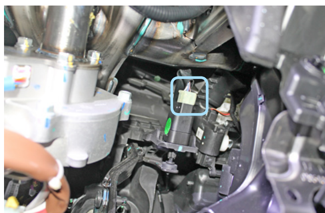
Фото 3.12. Местоположение разъёма педали тормоза
