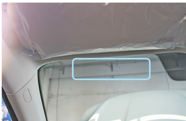
Фото 2.1. Возможное место установки антенного модуля
