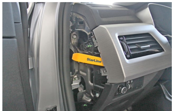
Фото 1.4. Снять левый воздуховод
