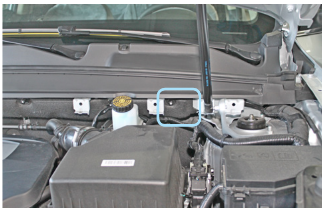
Фото 2.5. Возможное место установки сирены
