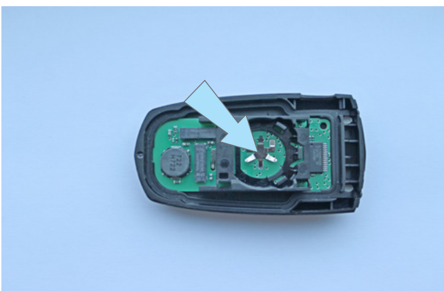
Фото 3.18. Контактная площадка (-) на плате ключа
