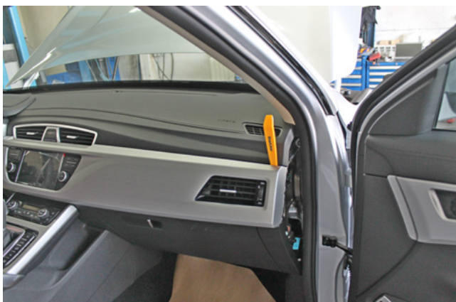
Фото 1.13. Снять пластиковую накладку передней панели
