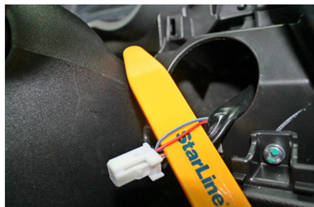
Фото 3.11. Управление кнопкой Старт-Стоп (красный и серо-синий)
