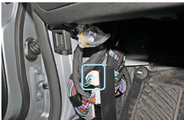
Фото 3.8. Местоположение белого разъёма в левой кик-панели
