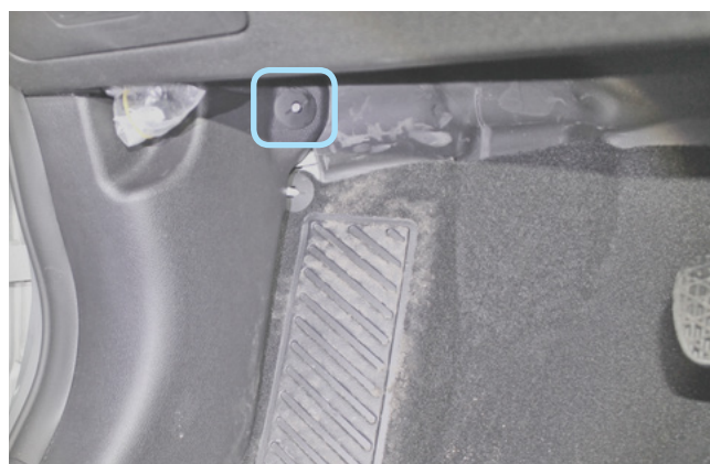
Фото 1.8. Клипса крепления накладки левой кик-панели
