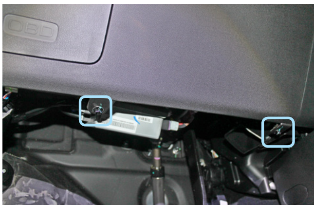
Фото 1.17. Болты крепления пластиковой накладки под рулевой колонкой
