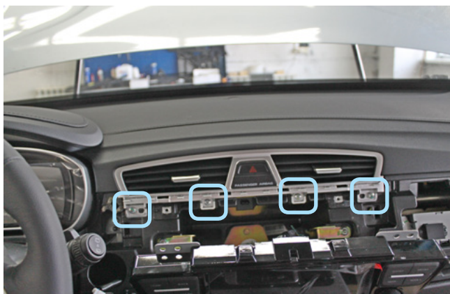
Фото 1.22. Магнитола снята. Саморезы крепления центральных воздуховодов
