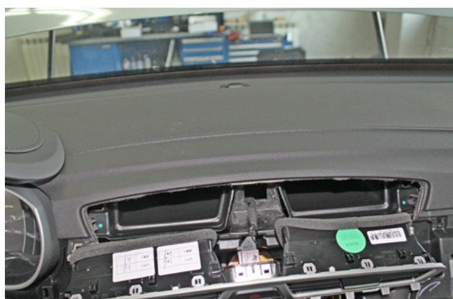
Фото 1.24. Центральные воздуховоды сняты
