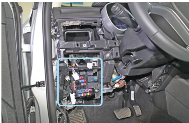
Фото 3.20. Местоположение монтажного блока предохранителей
