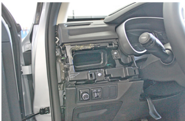
Фото 1.5. Левый воздуховод снят
