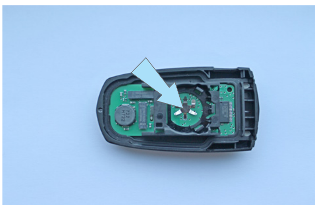
Фото 3.18. Контактная площадка (-) на плате ключа
