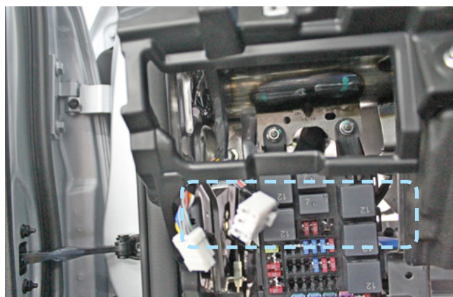
Фото 2.10. Пример расположения центрального блока охранно-телематического комплекса
