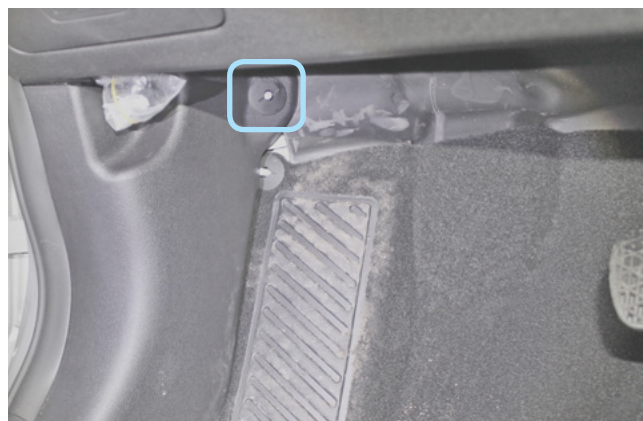
Фото 1.8. Клипса крепления накладки левой кик-панели
