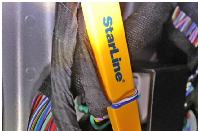
Фото 3.9. Управление центральным замком (синий и бело-синий)
