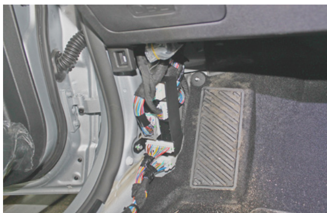
Фото 1.9. Накладка левой кик-панели снята
