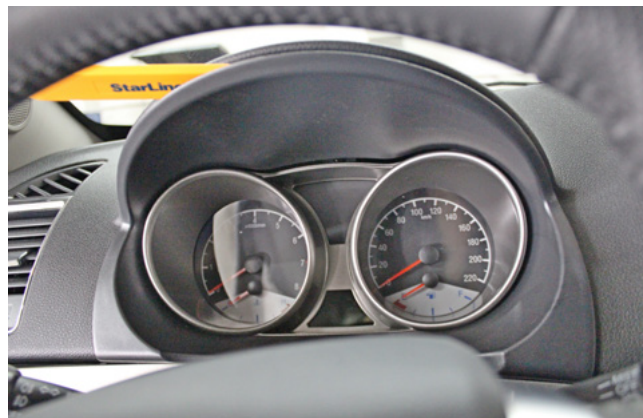
Фото 1.7. Снять декоративную накладку панели приборов
