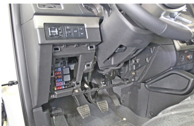
Фото 1.5. Пластиковая накладка под рулевой колонкой снята
