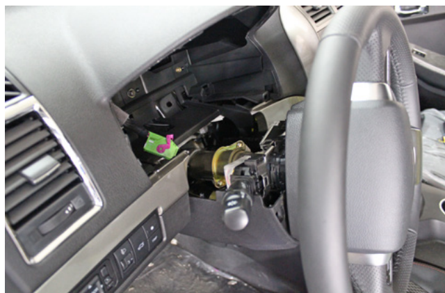
Фото 1.13. Верхняя часть кожану рулевого вала снята
