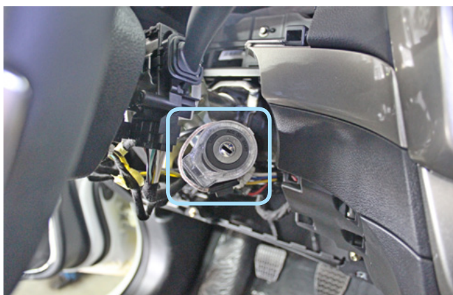
Фото 3.14. Антенна модуля обхода штатного иммобилайзера на замке зажигания
