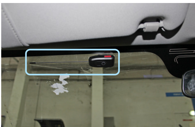
Фото 2.1. Возможное место установки антенного модуля
