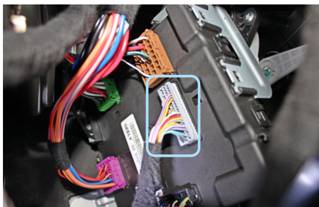
Фото 3.6. Местоположение разъёма на блоке BCM
