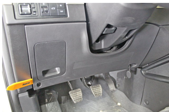
Фото 1.4. Снять пластиковую накладку под рулевой колонкой
