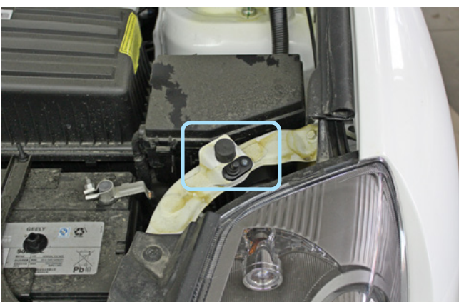
Фото 2.7. Возможное место установки концевика капота
