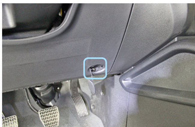
Фото 1.3. Саморез крепления пластиковой накладки справа
