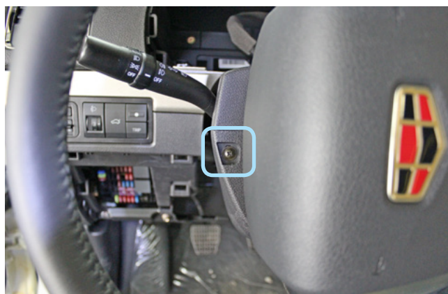
Фото 1.11. Саморез крепления верхней части кожуха рулевого вала слева
