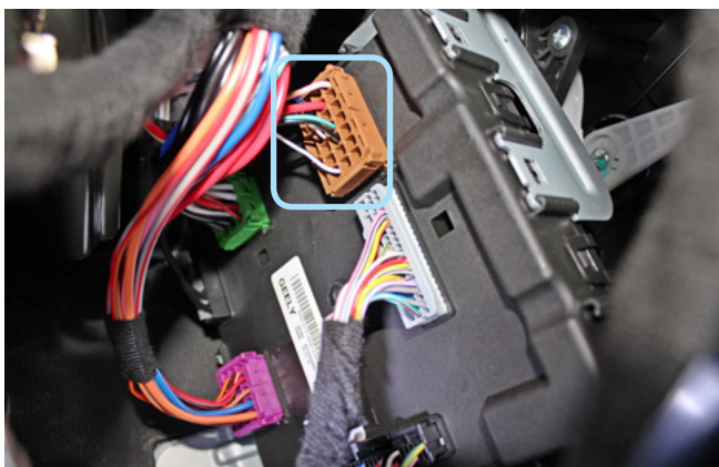
Фото 3.4. Местоположение разъёма на блоке BCM
