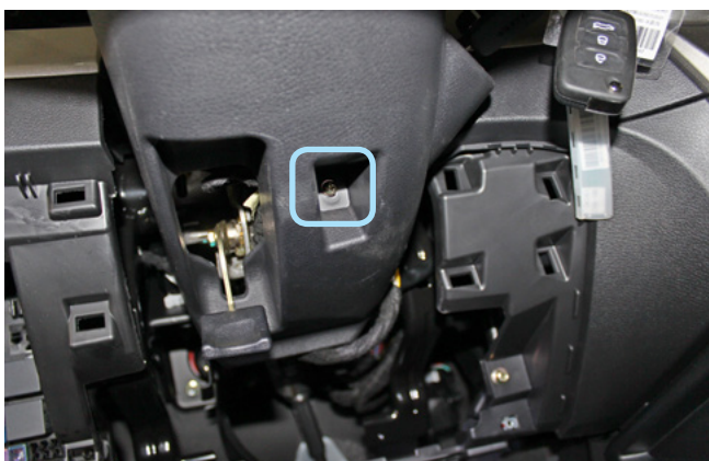
Фото 1.14. Саморез крепления нижней части кожану рулевого вала
