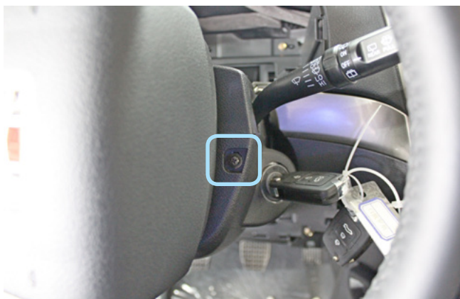
Фото 1.12. Саморез крепления верхней части кожану рулевого вала справа
