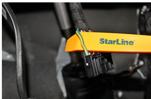
Фото 3.3. Шина CAN-A (жёлто-зелёный и зелёно-чёрный)
