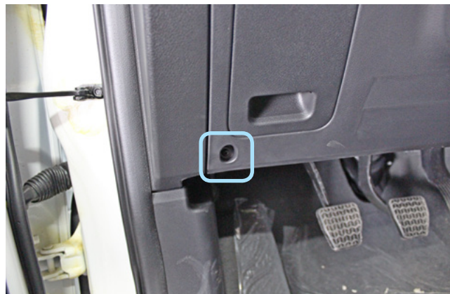
Фото 1.2. Саморез крепления пластиковой накладки слева
