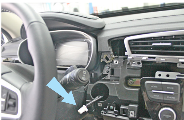
Фото 3.10. Местоположение разъёма кнопки Старт-Стоп
