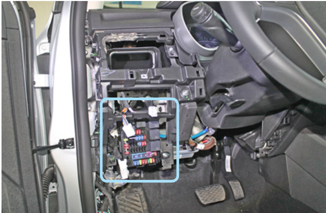
Фото 3.20. Местоположение монтажного блока предохранителей
