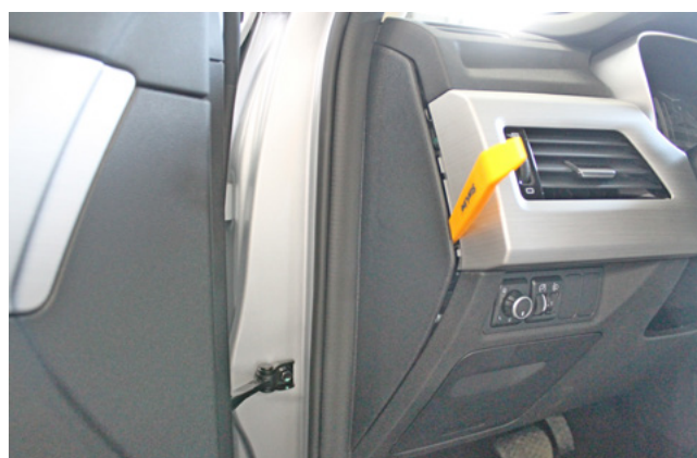
Фото 1.2. Снять левую боковую накладку передней панели
