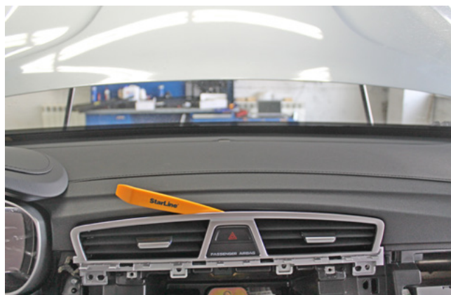
Фото 1.23. Снять центральные воздуховоды
