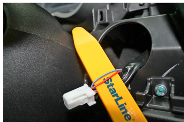
Фото 3.11. Управление кнопкой Старт-Стоп (красный и серо-синий)
