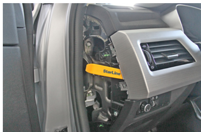
Фото 1.4. Снять левый воздуховод
