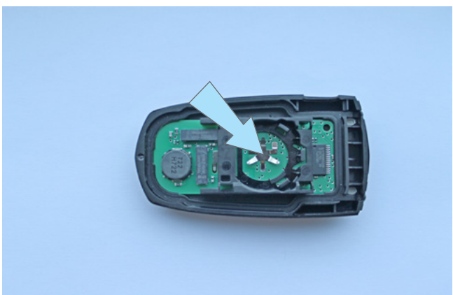
Фото 3.18. Контактная площадка (-) на плате ключа
