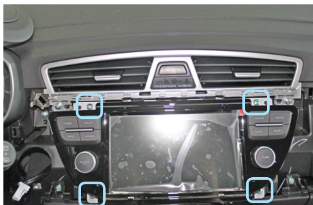
Фото 1.21. Саморезы крепления магнитолы
