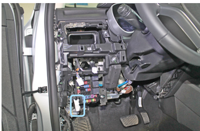
Фото 3.4. Местоположение диагностического разъёма OBD II
