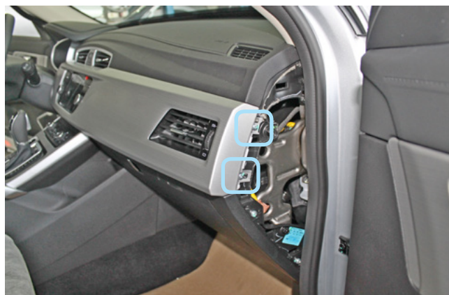
Фото 1.12. Боковая накладка передней панели снята. Саморезы крепления накладки передней панели
