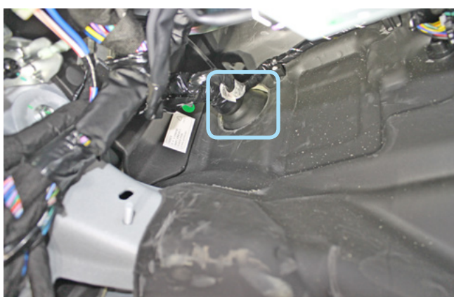
Фото 2.7. Штатный уплотнитель. Вид со стороны салона
