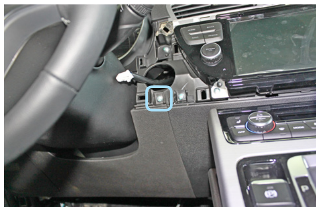
Фото 1.16. Саморез крепления накладки под рулевой колонкой
