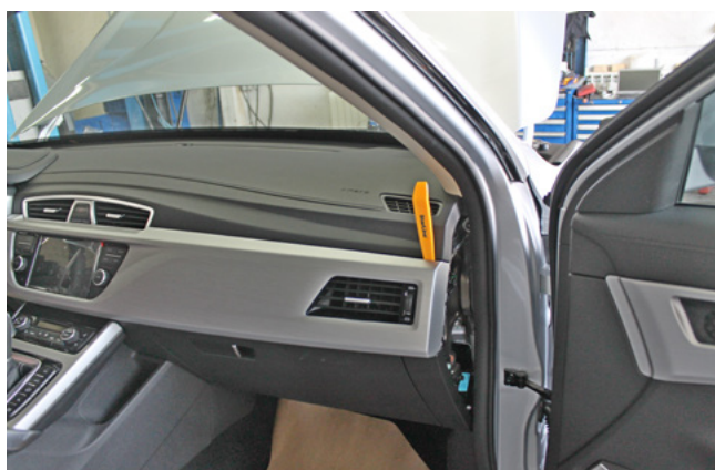
Фото 1.13. Снять пластиковую накладку передней панели
