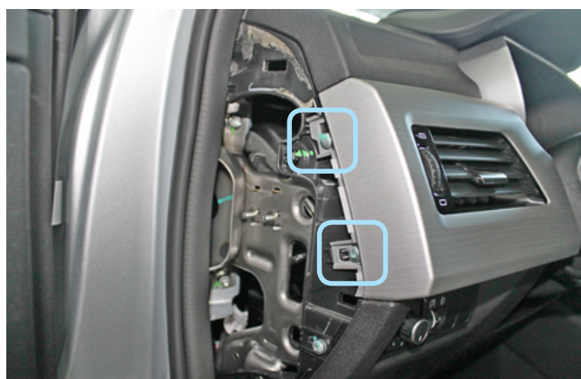
Фото 1.3. Боковая накладка передней панели снята. Саморезы крепления левого воздуховода
