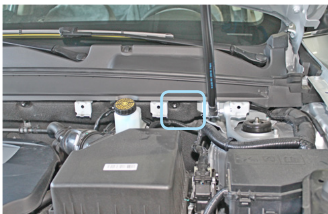
Фото 2.3. Возможное место установки сирены
