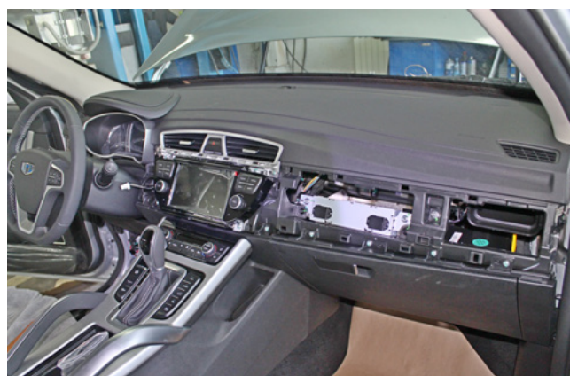
Фото 1.14. Пластиковая накладка передней панели снята
