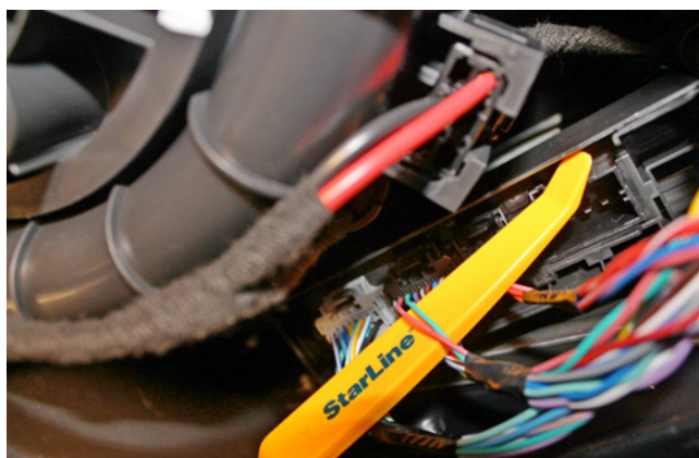
Фото 3.17. Провода штатной антенны в жгуте чёрного разъёма блока PEPS (розовый и зелёный)
