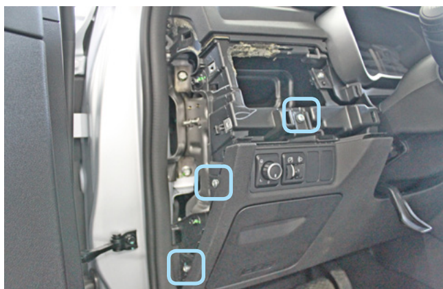
Фото 1.15. Саморезы крепления накладки под рулевой колонкой
