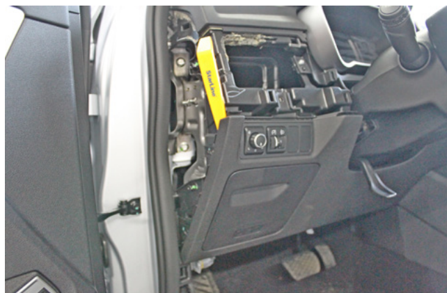
Фото 1.18. Снять пластиковую накладку под рулевой колонкой
