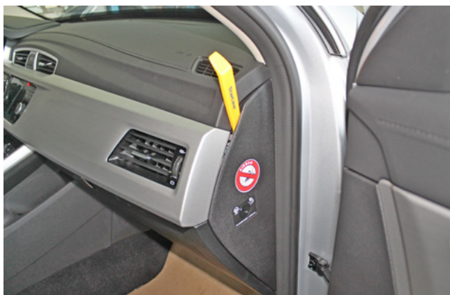
Фото 1.11. Снять правую боковую накладку передней панели
