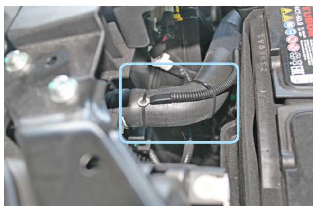
Фото 2.6. Крепление датчика температуры двигателя
