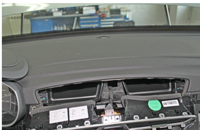
Фото 1.24. Центральные воздуховоды сняты
