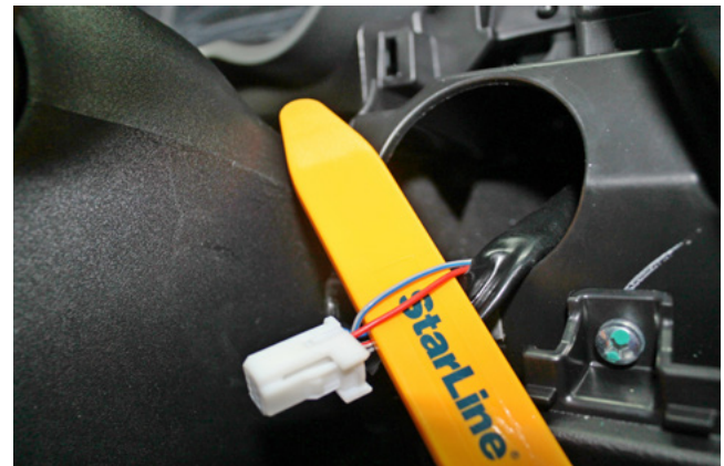
Фото 3.11. Управление кнопкой Старт-Стоп (красный и серо-синий)
