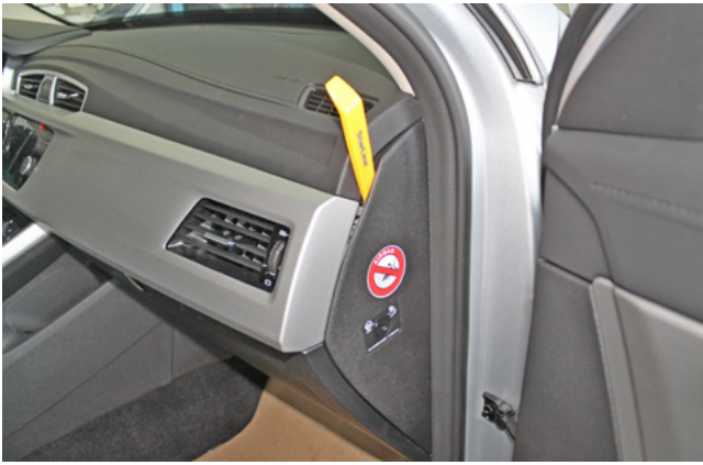
Фото 1.11. Снять правую боковую накладку передней панели
