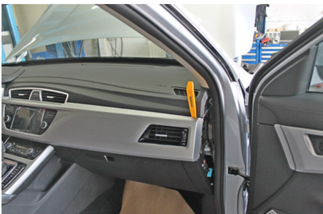
Фото 1.13. Снять пластиковую накладку передней панели
