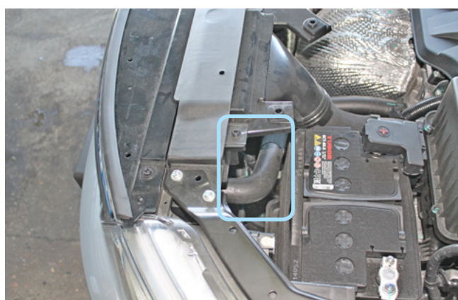
Фото 2.5. Место установки датчика температуры двигателя
