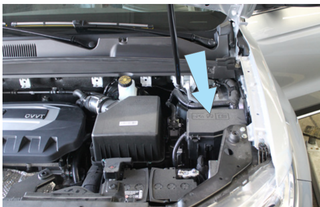
Фото 2.8. Возможное место установки подкапотного блока R6
