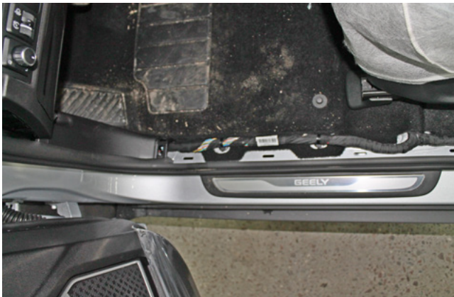
Фото 1.7. Накладка порога двери водителя снята
