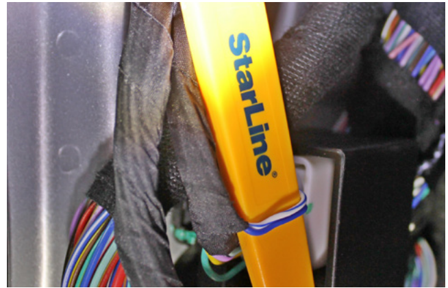
Фото 3.9. Управление центральным замком (синий и бело-синий)
