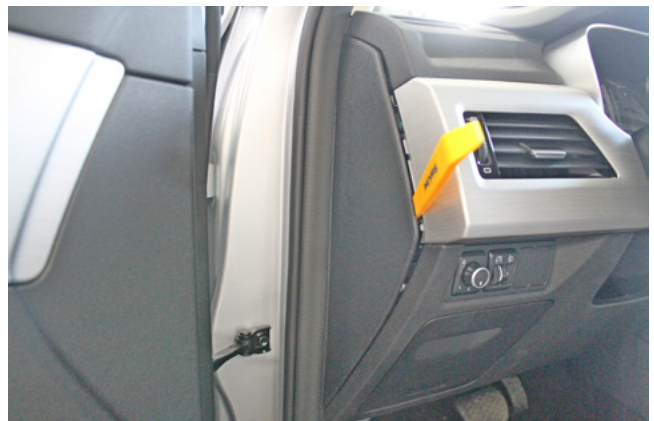
Фото 1.2. Снять левую боковую накладку передней панели
