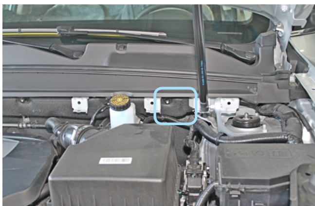
Фото 2.3. Возможное место установки сирены
