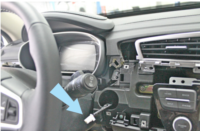
Фото 3.10. Местоположение разъёма кнопки Старт-Стоп
