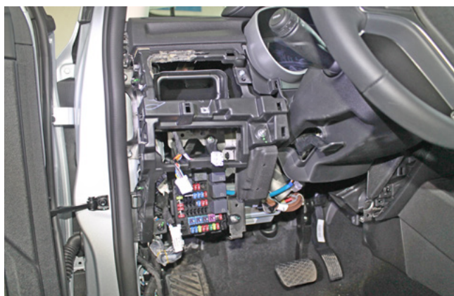
Фото 1.19. Пластиковая накладка под рулевой колонкой снята
