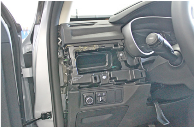
Фото 1.5. Левый воздуховод снят
