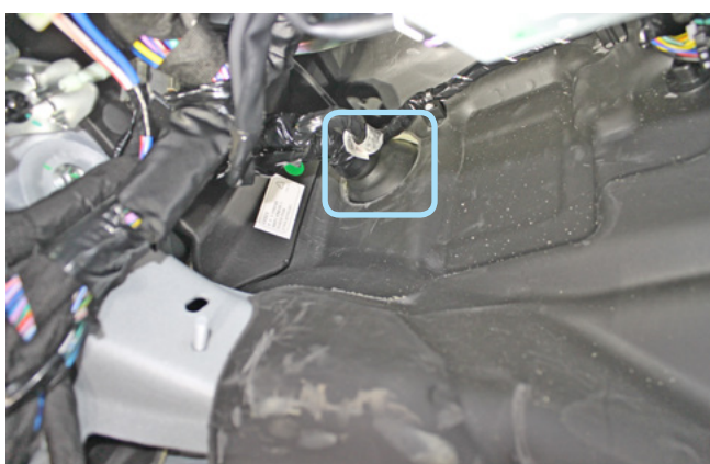
Фото 2.7. Штатный уплотнитель. Вид со стороны салона
