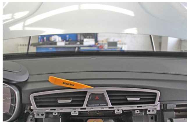
Фото 1.23. Снять центральные воздуховоды
