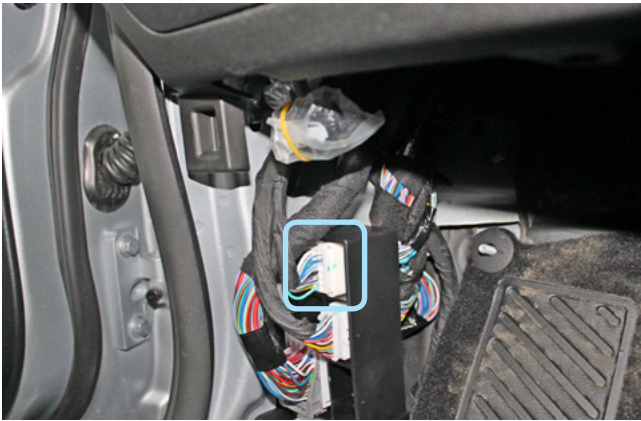
Фото 3.8. Местоположение белого разъёма в левой кик-панели
