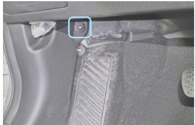
Фото 1.8. Клипса крепления накладки левой кик-панели
