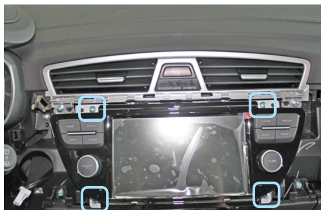
Фото 1.21. Саморезы крепления магнитолы
