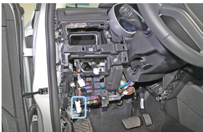
Фото 3.4. Местоположение диагностического разъёма OBD II
