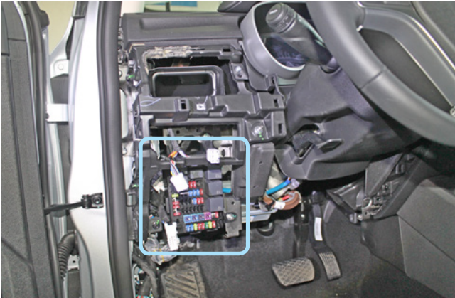
Фото 3.20. Местоположение монтажного блока предохранителей
