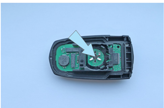
Фото 3.18. Контактная площадка (-) на плате ключа
