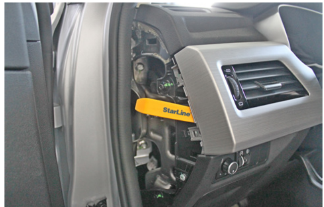
Фото 1.4. Снять левый воздуховод
